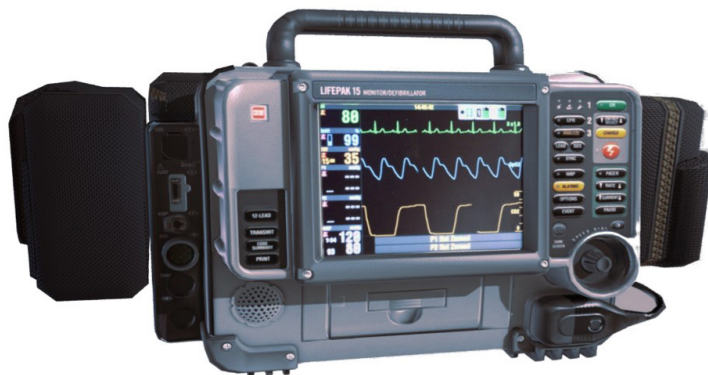
Rycina 1. Monitor/defibrylator LIFEPAK 15 [opracowanie własne]
