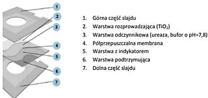
Rysunek 2. Budowa slajdu do oznaczania mocznika
