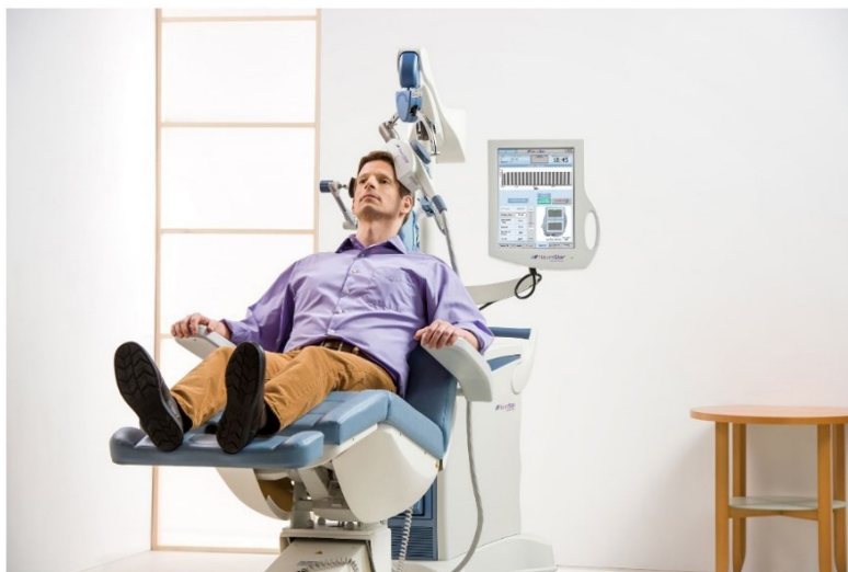
Rycina 4. Urządzenie do TMS „NeuroStar” firmy Neuronetics. Od 25 marca 2024 r. zatwierdzone przez FDA do terapii pacjentów w wieku 15 – 21 lat. Materiały promocyjne producenta. Dostęp z dnia 12.05.2024. [41]
